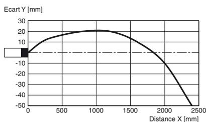
Écart possible entre l'axe optique et l'objet.
