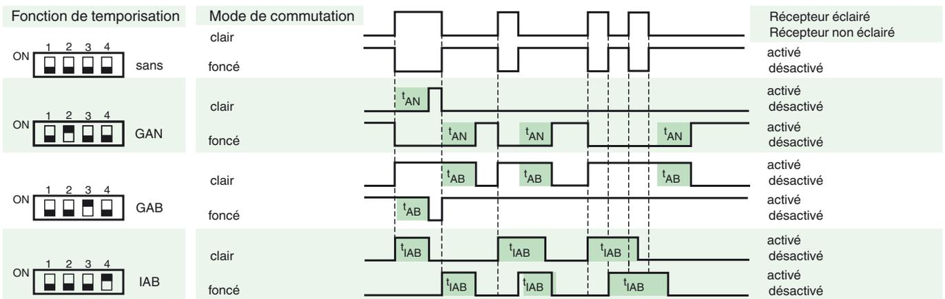
Les temps  $t_{AN}$ ,  $t_{AB}$  et  $t_{IAB}$  sont réglables de 0,1 ... 10 s.
