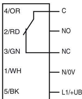
Las funciones de relé «abrir» y «cerrar» se refieren al modo de conmutación «conmutación clara», en cuya configuración se encuentra el conmutador claro/oscuro en la parte superior de la carcasa (= estado en la entrega).
