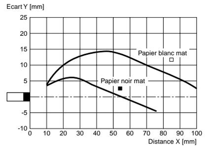
Ecart possible entre l'axe optique et l'objet.
