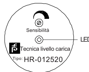
Convertitore electr. HR-012520 incorporato nella custodia di collegamento
